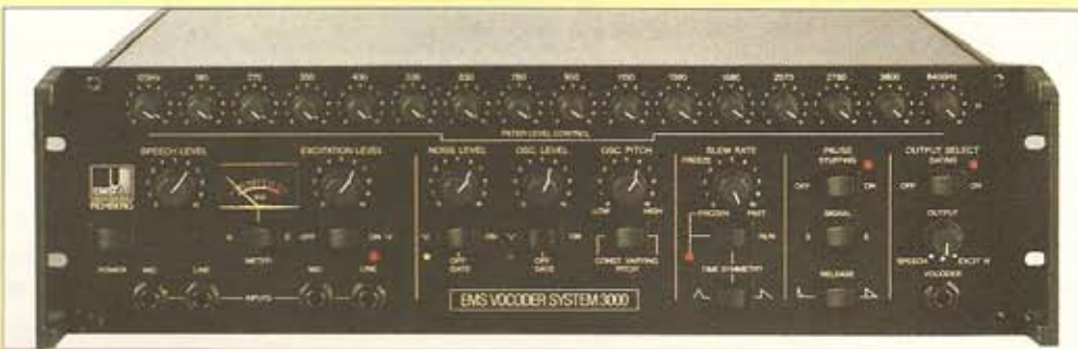
EMS3000 : un vocoder récent, version améliorée du 2000, avec accès aux niveaux des filtres, commercialisé par la branche allemande d'EMS.
