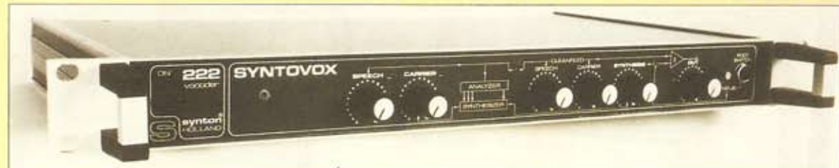
Synton 222 : le petit Syntovox à huit canaux, très (trop) dépouillé : aucun dispositif de reconnaissance voyelle/consonne, et des filtres à 12dB/octave (contre 54 sur le 221).
