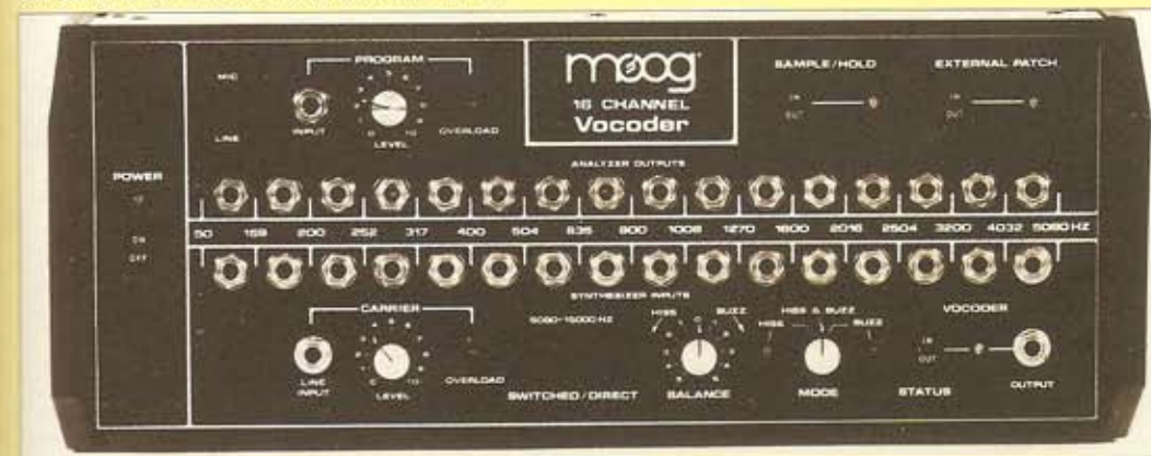
La version Moog du Vocoder d'Harald Bode, 16 filtres repatchables et un prix spécial importation : 44460 F HT à l'époque.
