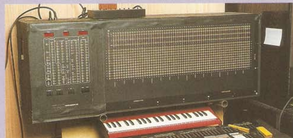
Le Digisequencer, version moderne du Matrisequencer cache un Atari en son sein.
