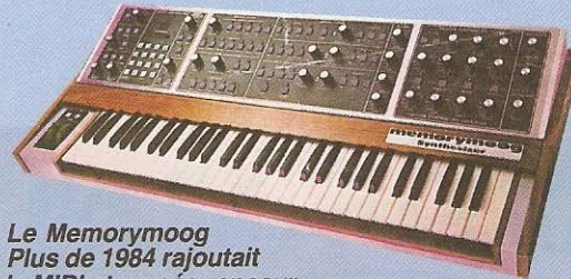
Memorymoog. Tellement dur à accorder, mais quel son ! Trois oscillateurs, un LFO séparé, et d'énormes possibilités de modulation. Impressionnant de puissance.
